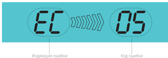
Рисунок 19. Пример индикации ошибки
